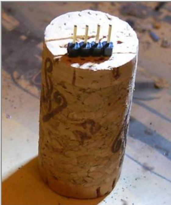
Das nächste Foto zeigt, wie man damit beim Löten arbeiten kann. Am gegenüberliegenden Ende gehört die Platine durch einen geeigneten Gegenstand abgestützt, damit auch alles gerade liegt.
