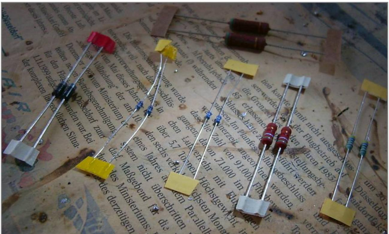
Speziell die beiden 0,6W Typen – 12ohm und 22ohm – lassen sich mitunter schwer auseinanderhalten. Deswegen sollte man hier ruhig mit einem Ohmmeter bzw. Multimeter nachmessen. Die 12ohm sind näher an den Reglern, die 22ohm in Nähe der Platine-Kante.
