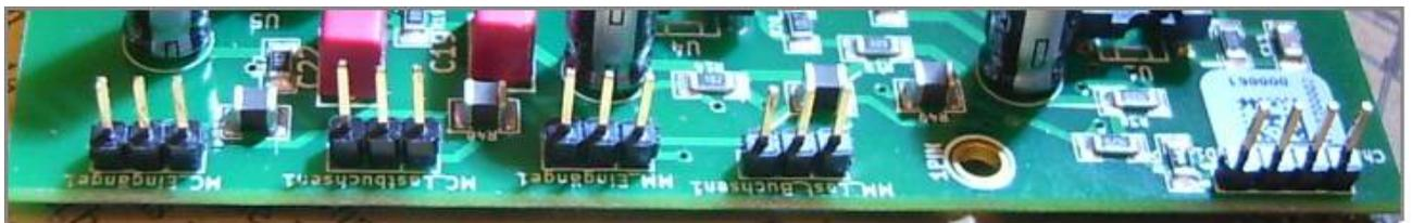
Und da wären noch 2 Stück 2er Leisten neben dem OpAmp der zweiten Verstärkungs-Stufe. Diese dienen später der Umschaltung der Verstärkung.
