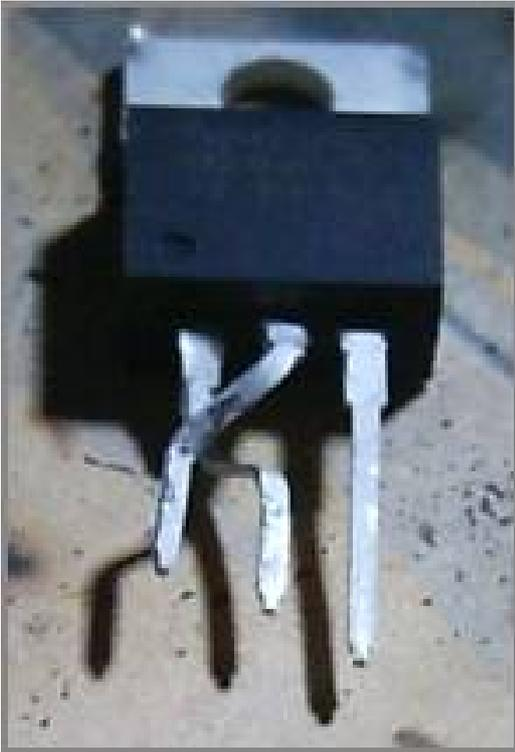
Die drei Beinchen liegen jetzt nicht mehr unbedingt in einer Ebene mit dem Gehäuse, und dies führt später zu einem leicht schiefem Einbau des Reglers. - Das ist aber nur ein kosmetisches Problem, und wiegt auf jeden Fall geringer, als durch übermässiges Biegen den Bruch eines Beinchens zu provozieren!
